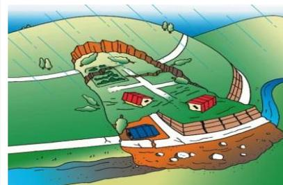
斜面の一部あるいは全部が地下水の影響と重力によってゆっくりと斜面下方に移動する現象です。
