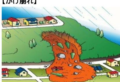
降雨時に地中にしみこんだ水分によって不安定化した斜面が急激に崩れ落ちる現象です。
