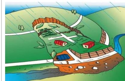
斜面の一部あるいは全部が地下水の影響と重力によってゆっくりと斜面下方に移動する現象です。
