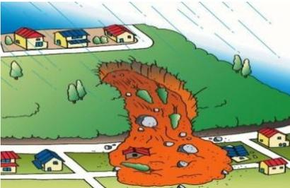
降雨時に地中にしみこんだ水分によって不安定化した斜面が急激に崩れ落ちる現象です。
